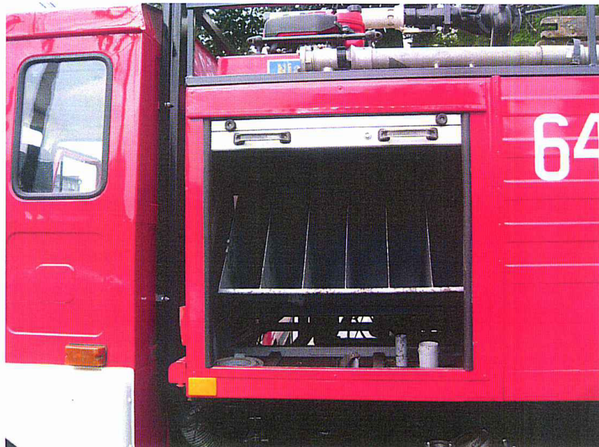
Fot. 15. Schowek na węże gaśnicze \varnothing 75 do dł. 240 [m]
