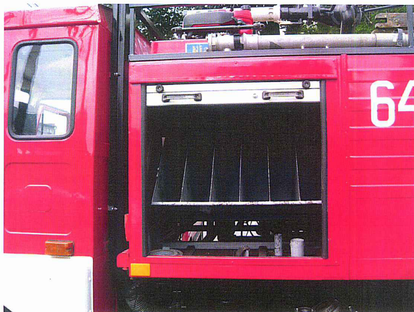
Fot. 15. Schowek na węże gaśnicze Ø 75 do dł. 240 [m]
