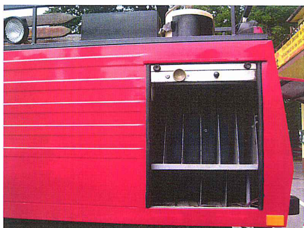
Fot. 16. Schowek na węże gaśnicze \varnothing 52 do dł. 240 [m]
