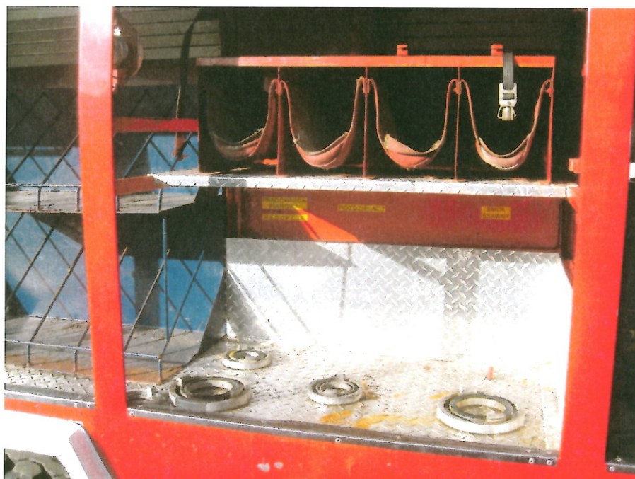
Fot. 11. Schowek na końcówki węży
